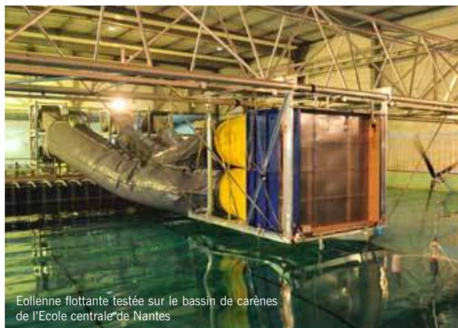
Eolienne flottante testée sur le bassin de carènes de l'Ecole centrale de Nantes
